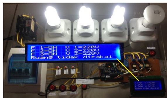
Gambar 10 Tampilan hasil pengkondisian ON terhadap MCB untuk fase-R, fase-S, dan fase-T
