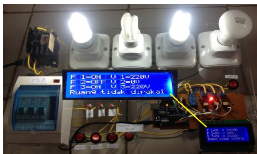
Gambar 9 Tampilan hasil pengkondisian ON terhadap MCB untuk fase R dan fase-T
