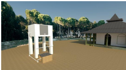
Gambar 1. Tampak depan bak penampungan beton.
