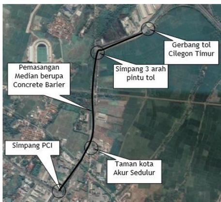
**Gambar 9.** Pemasangan Median Jalan
