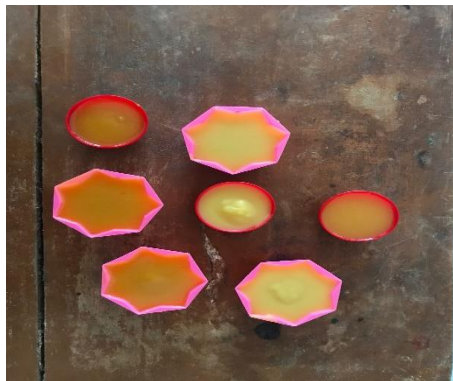
Gambar 7. Proses pencetakan sabun kedalam cetakan
