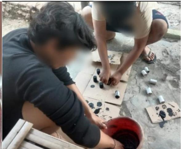
Gambar 7. Pencetakan briket daun kelapa sawit.
