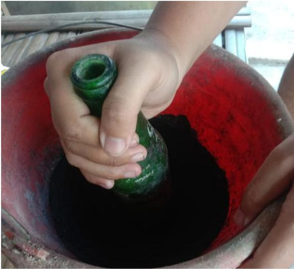
Gambar 4. Penumbukan arang daun kelapa sawit perekat adonan briket.
