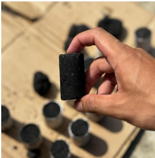
Gambar 8. Briket daun kelapa sawit yang telah melewati proses penjemuran dan siap pakai.
