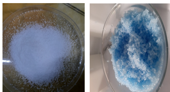
Gambar 1. Superabsorbent polymer sebelum dan sesudah swelling
