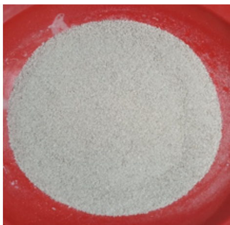
Gambar 1. Adsorben selusosa bakterial nata de coco hasil pengeringan dengan oven pada suhu 80°C selama 8 jam dan pengayakan 30 mesh.
