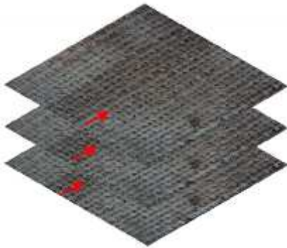
Gambar 1. Susunan Komposit Serat jute 3 lapis
