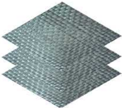
Gambar 2 Susunan Komposit Serat e-glass 3 lapis
