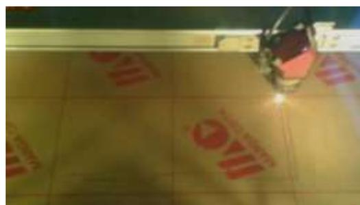
**Gambar 2.** Proses pemotongan dan pembolongan akrilik menggunakan laser.
