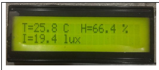
Gambar 11. LCD karakter 20x2 menampilkan nilai parameter fisis
