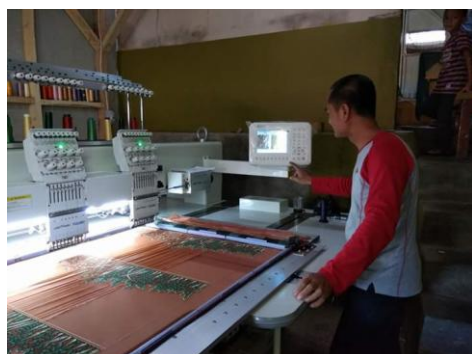
Gambar 14. Pengrajin sedang Mengoperasikan Mesin Bordir Komputer. Sumber: Faaris Naura Bordir.
