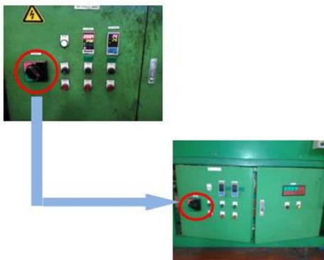
**Gambar 7.** Selektor Mesin UHF Dari Posisi *ON* ke Posisi *OFF*
