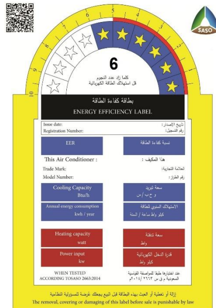
Gambar 1. Pemberian bintang Standart Arab Saudi Contoh label efisiensi energi Bintang 6 untuk paket tunggal AC tipe jendela ( CC \leq 24000 BTU / jam) –Pemanasan dan pendinginan
