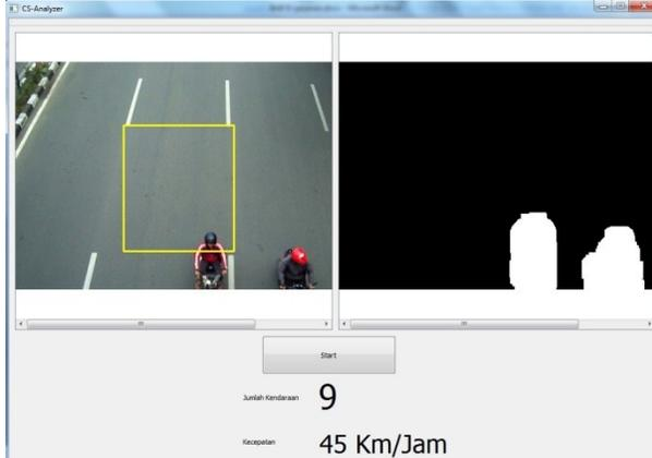
Gambar 13. Hasil pembacaan kecepatan sepeda motor.
