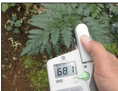
Gambar 2. Alat pengukur tingkat hijau daun (angka 68,1 menunjukkan angka kehijauan daun siap panen)
