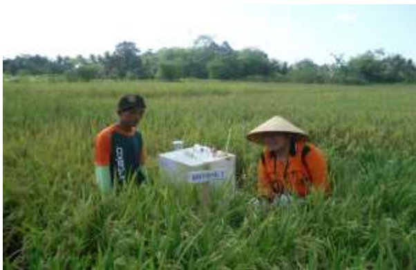
Gambar 2. Pengambilan gas metan di lapangan
