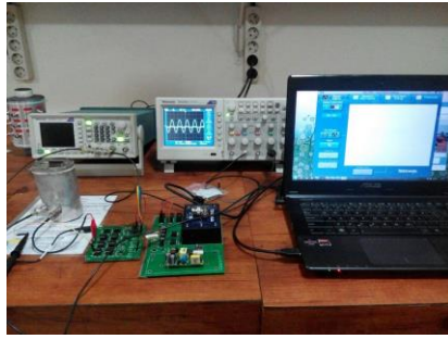
Gambar 4. Rangkaian pengukuran kapasitansi menggunakan sensor kapasitif 2-Channel yang dirangkai bersama oscilloscope , signal generator , CV circuit serta komputer.
