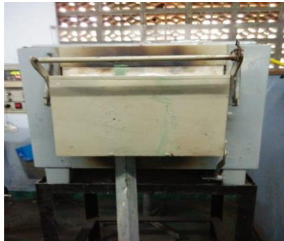
Gambar 2. Furnace dengan temperatur 110°C selama 1 jam untuk menghilangkan kadar air batu bara.
