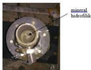
Gambar 13. Mineral hidrofilik terkumpul di antara letak sparger dan keluaran tailing
