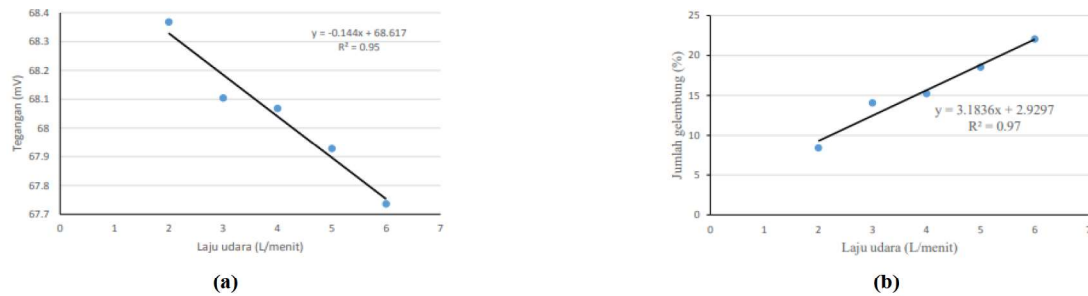
Gambar 8. (a) Pengaruh Laju Udara terhadap Tegangan Sistem Dua Fasa (air-udara) (b) Pengaruh Laju Udara terhadap Jumlah Gelembung Sistem Dua Fasa (air-udara)
