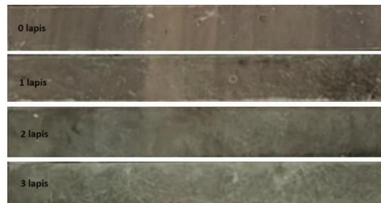
**Gambar 2** Sampel komposit dengan 0, 1, 2, dan 3 lapis fiberglass CSM.
