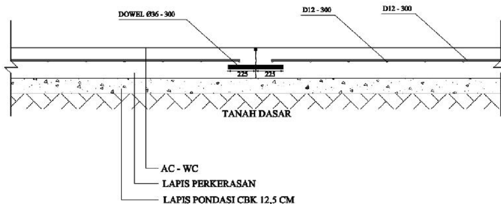
Gambar 2. Potongan Memanjang (B-B) Perkerasan Kaku (Sumber: Hasil Analisis, 2015)
