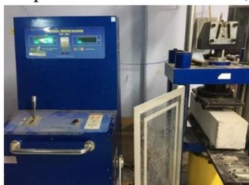
**Gambar 4.** Pengujian Kuat Lentur Balok Beton
