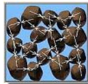
Gambar 2. Kondisi Partikel Tanah Saat Normal Sebelum Terjadinya Kenaikan Tegangan Air Pori Sumber : M. Mabruur, 2009
