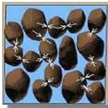
Gambar 3. Kondisi Partikel Tanah Saat Mengalami Getaran Saat Terjadinya Kenaikan Tegangan Air Pori Sumber : M. Maburur, 2009
