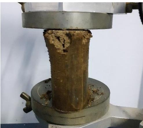
**Gambar 14.** Pola Keruntuhan Tanah dengan Kadar Slag Semen 30%
