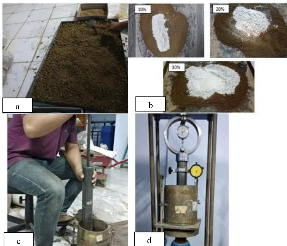
Gambar 2. a. Sampel tanah dengan kondisi kering oven; b. Sampel tanah yang dicampur dengan semen slag; c. Pengujian pemadatan; d. Pengujian CBR
