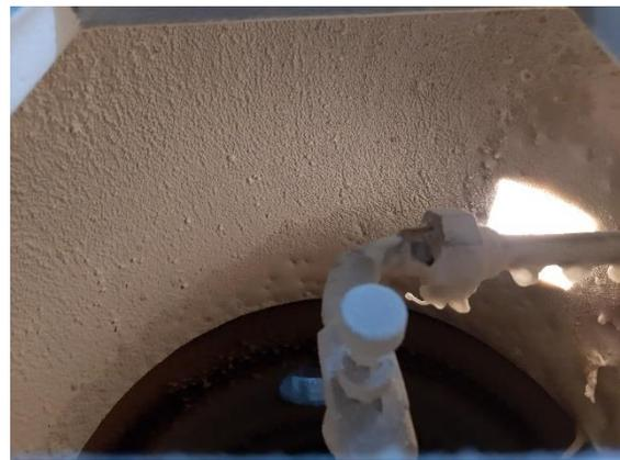
**Gambar 5.** Deposit partikel pada area dekat nosel di bagian *top cylinder* pada kondisi konsentrasi 30%-b/b dan laju alir udara 410 m<sup>3</sup>/h.
