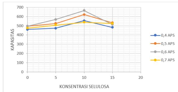
Gambar 2. Hasil kapasitas absorpsi air pada produk superabsorben
