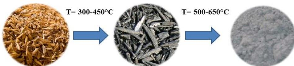
**Gambar 2.** Sintesis karbon dengan metode karbonisasi(Sumber: Ugheoke dan Othman, 2012)
