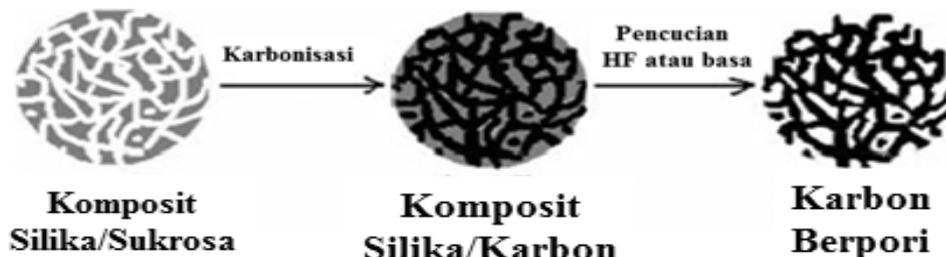
**Gambar 7.** Prinsip dasar pembuatan karbon berpori (Sumber: Pang, et al., 2004)
