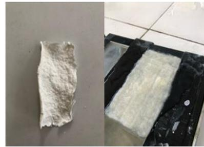
**Gambar 4.** Pencetakan serat selulosa asetat menjadi filter masker dengan pelat kaca sederhana
