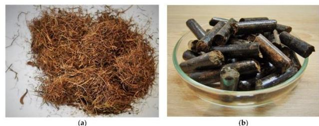
**Gambar 2.** Bahan baku biopelet: (a) Serbuk TKS dan (b) Bahan bakar biopelet (Brunerová et al., 2018)
