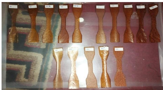
Gambar 1. Sampel uji kuat tarik dan elongasi sesuai ASTM D638
