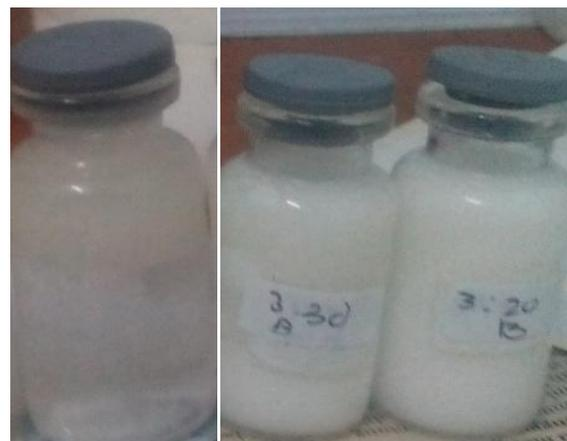
**Gambar 1.** Penampakan emulsi minyak air (a) 3 menit, 2000 rpm (b) 3 menit 6000 rpm dan 4000 rpm
