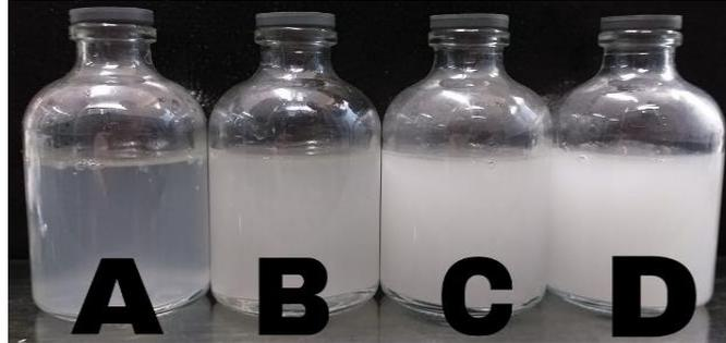
**Gambar 5.** Larutan Sampel dari Proses Enkapsulasi Minyak Biji Bunga Matahari (SO) ke dalam Nanopartikel Kitosan Dengan Rasio: (a) Tanpa SO, (b) 2:1, (c) 1:1, (d) 1:2
