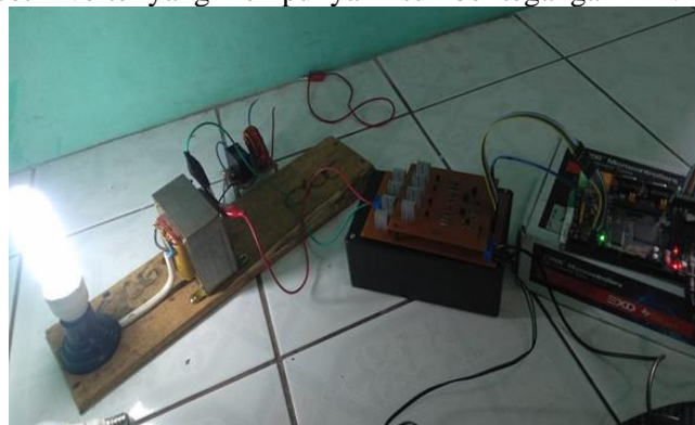
Gambar 12 Pengujian Dengan Beban Lampu 20 Watt.
