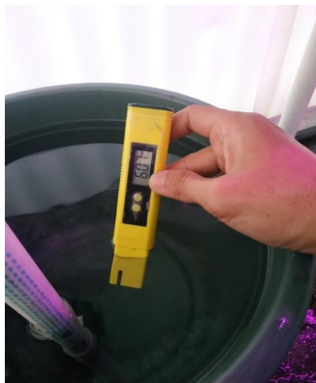
Gambar 11. Pengukuran pH Air Menggunakan Ph Meter Digital
