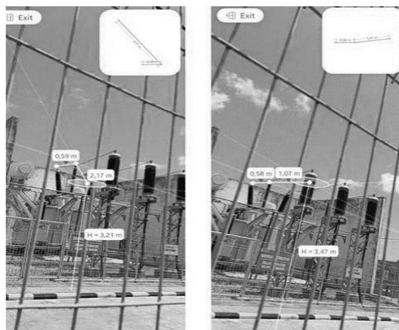
Gambar 3. Jarak LA dengan Transformator dengan Aplikasi ARPlan 3D
