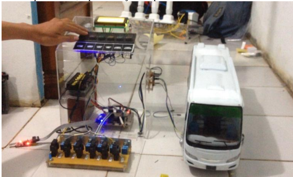
Gambar 8 Sistem kontrol berbasis mikrokontroler ATmega32 untuk tampilan pantauan kondisi instalasi kelistrikan pada otobis
