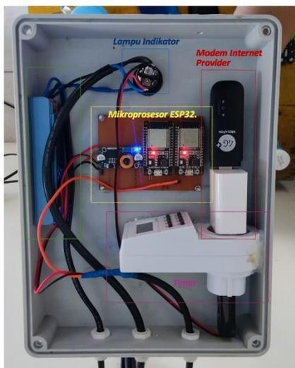
Gambar 4. Instalasi sistem pengiriman data konsentrasi gas radon dan level air tanah.
