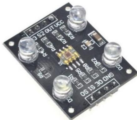
Gambar 1. Sensor Warna TCS3200
