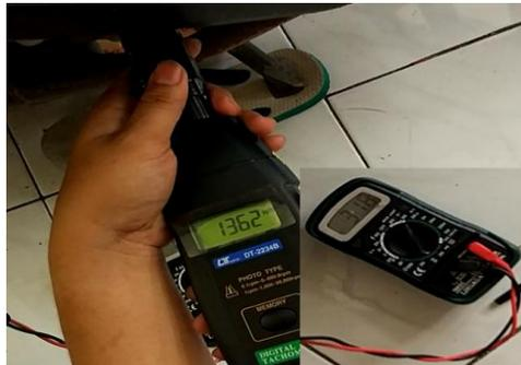
Gambar 6 Pengukuran kecepatan terhadap tegangan *alternator*
