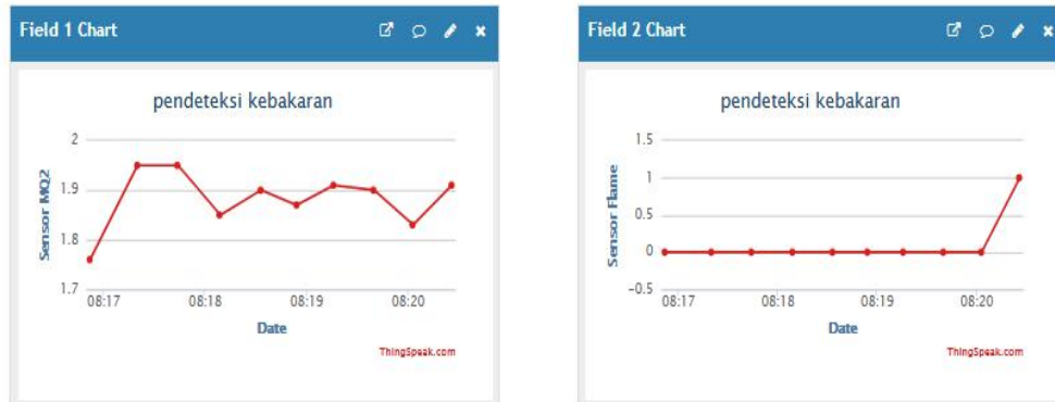
Gambar 6 Hasil Pembacaan Sensor MQ2 Dan Sensor Flame Pada Web Thingspeak
