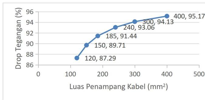
Gambar 5. Drop tegangan pada ujung saluran Site kebun A dibandingkan dengan penggunaan luas penampang kabel yang berbeda.
