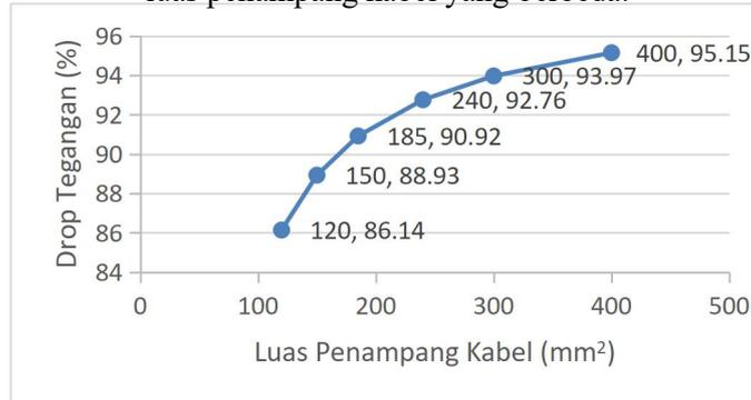
Gambar 7. Drop tegangan pada ujung saluran Site kebun B dibandingkan dengan penggunaan luas penampang kabel yang berbeda.
