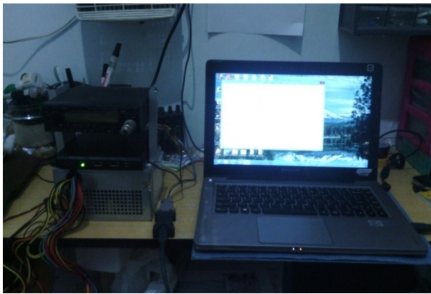
Gambar 4 Perangkat stasiun penerimaan digipeater pada jaringan APRS
