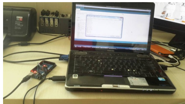
Gambar 6. Antarmuka Modul Arduino dengan Komputer
