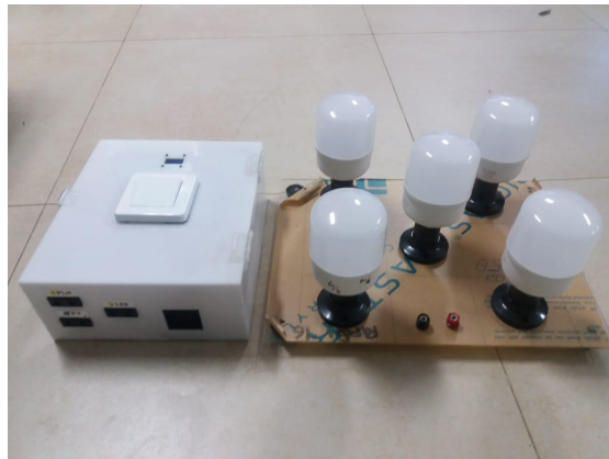
Gambar 14. Desain modul LED (kanan) dan packaging konverter (kiri)
