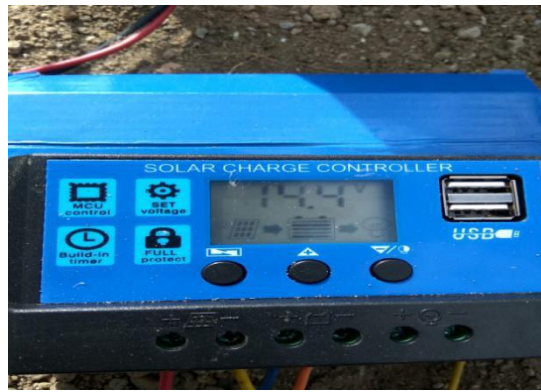
Gambar 12 Kondisi Saat Solar Charger Baterai Telah Full
