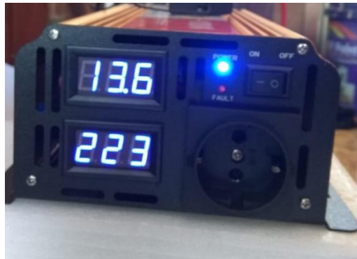
Gambar 16 Tegangan Keluaran Inverter Sumber Baterai 12 V 100Ah
