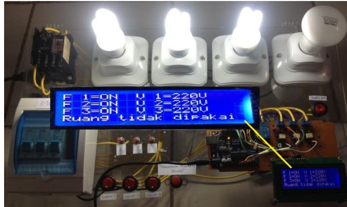
Gambar 1 Tampilan hasil pengkondisian ON terhadap MCB untuk fase-R, fase-S, dan fase-T
