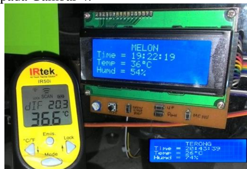
Gambar 4 Tampilan hasil pengukuran kinerja sistem untuk pantauan suhu dan kelembaban dalam ruangan smartgreenhouse
