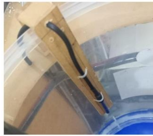
Gambar 15. Implementasi tata letak sensor suhu
