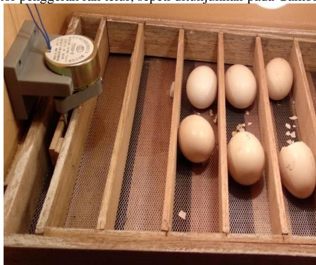
Gambar 9 Motor penggerak rak telur
