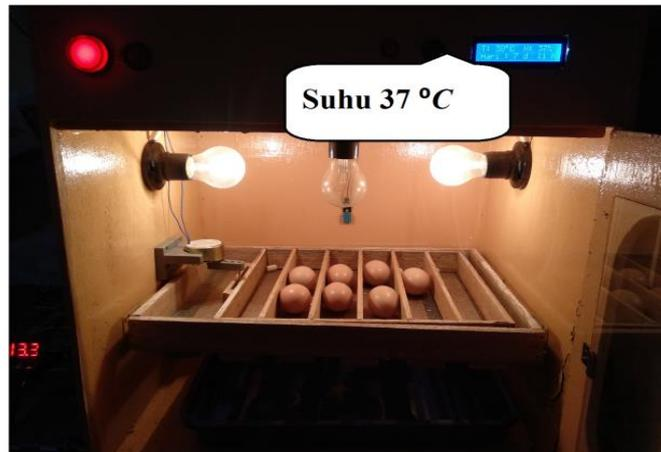
Gambar 12 Lampu *emergency/standby* padam, ketika penunjukan nilai suhu pada 37 °C
