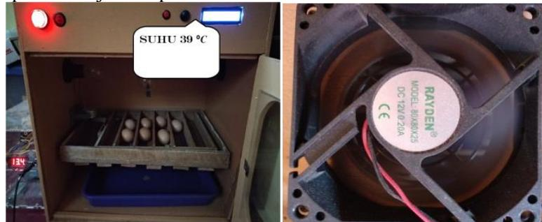
Gambar 13 Semua lampu di inkubator penetasan telur dalam kondisi padam dan kipas beroperasi, ketika suhu lebih dari 39 °C
