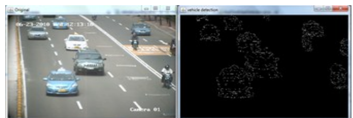
Gambar 3. Hasil dari proses deteksi tepi canny dan segmentasi
